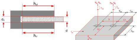
H<sub>min</sub> = Espesor mínimo del hormigón (mm)
